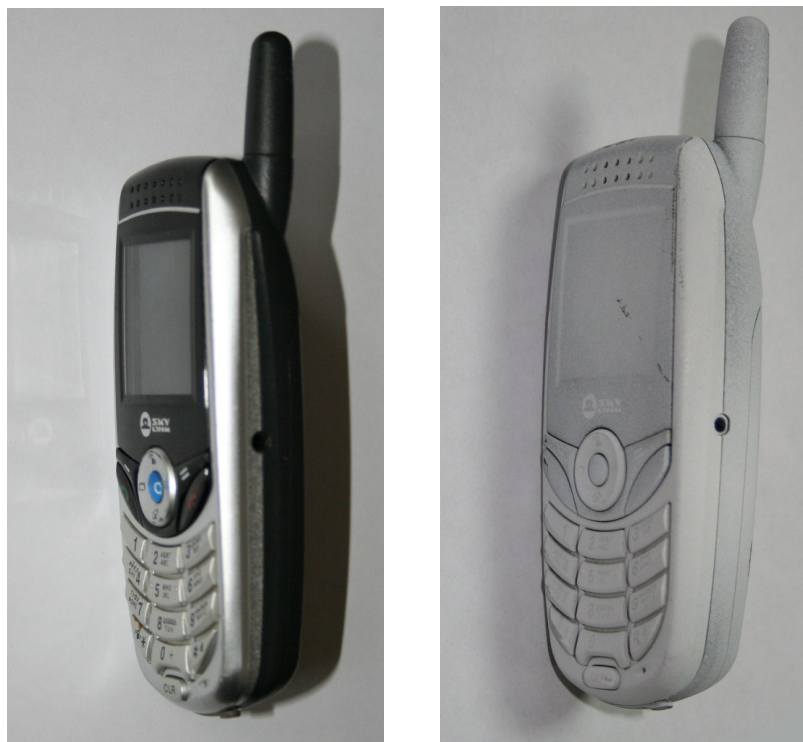
Объект сканирования «телефон» до и после обработки аэрозолем
