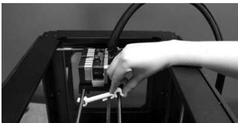
3б. Сейчас экструдерам не дает двигаться небольшая пластиковая деталь, прикрепленная к ремню оси X и стержням порталной системы. Не прилагая излишних усилий, открепите деталь от стержней и, повернув ее, снимите с ремня.
