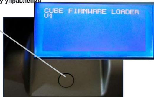
4. Продолжайте удерживать кнопку нажатой, пока на сенсорном экране не появятся сообщения "Settings Saved" (Настройки сохранены) и "Cube Firmware Loader [XX]". Теперь принтер находится в соответствующем режиме для загрузки обновления.
