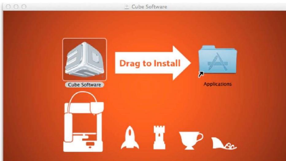
3. Если окно "Drag to install" (Перетащить для установки) не открылось, найдите драйвер "Cube" на панели устройства. Нажмите на "Cube" чтобы скачать программное обеспечение. **Примечание: Пользователям интернет-браузера Safari не нужно распаковывать .dmg, он распаковывается в процессе загрузки автоматически.**
