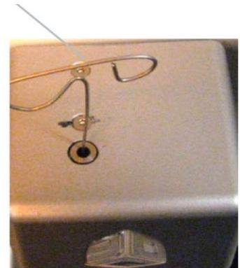
3. Выньте картридж из принтера и освободите прозрачную трубку от материала. Чтобы зафиксировать неиспользуемый материал, установите на картридж винт с накатной головкой. Более подробную информацию см. в разделе "Установка картриджа с материалом".
