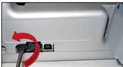
3. Плоской отверткой поверните предохранитель по часовой стрелке и вставьте его обратно в держатель. После замены предохранителя вставьте вилку шнура питания в розетку и включите питание.
