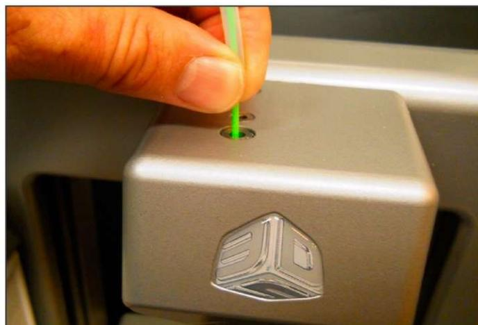
5. Затем она должна пройти через экструдер и выйти из наконечника в нижней части экструдера. Осторожно удалите выдавленный материал, не касаясь "ГОРЯЧЕГО" наконечника. Утилизируйте лишний материал.
