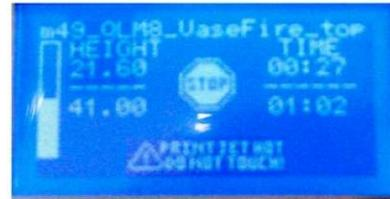
4. Процесс разогревания принтера занимает две (2) минуты. Во время разогрева горячий наконечник достигнет установленной производителем температуры. После достижения необходимой температуры начнется печать модели. После завершения печати на экране появится сообщение "Print Finished" (Печать закончена), для подтверждения нажмите флажок.
