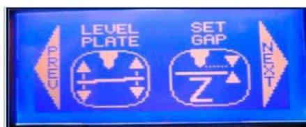
2. Коснитесь надписи "Set Gap". Печатный стол и экструдер займут положение для регулировки зазора. Вставьте лист бумаги между наконечником и столом. Если лист бумаги не проходит между наконечником и столом, на сенсорном экране нажмите стрелку вниз.
