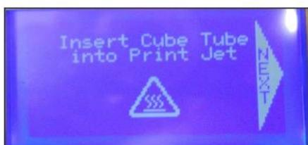
Вставьте трубку принтера Cube в отверстие сверху экструдера.
